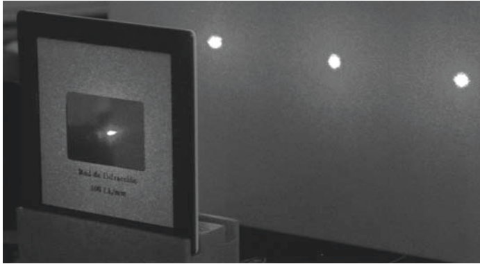
Experimento de difracción. Un láser atraviesa una red de difracción y genera un patrón de luces y sombras alternadas en la pantalla.
