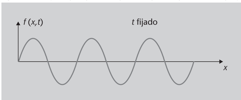
Figura 7. Función f(x,t) que depende de la posición, x , y del tiempo, t , con el tiempo fijo
