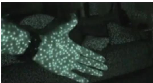
Fotografía infrarroja en la que se muestra la nube de puntos infrarrojos que emite la Kinect para obtener la profundidad de la imagen. Fuente: [www.mattcutts.com](http://www.mattcutts.com)
