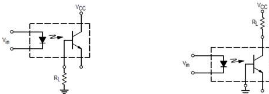
Figura 4.79: Circuitos básicos con optoacoplador con fototransistor
